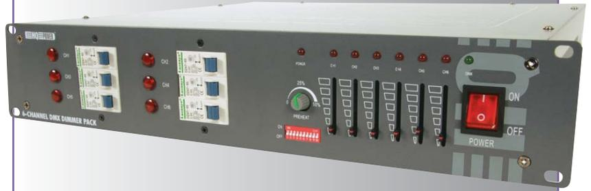
6 canaux réglés par DMX512 ou 0-10V. Indication par LED et variateur-fader pour chaque canal. Préchauffage réglable entre 0 et 50%
