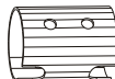
extension pipe / tube de rallonge / verlengbuis / tubo de extensión / Verlängerungsrohr / tubo extensível / łącznik 8 cm (x1)
